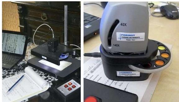
Figura 1: a sinistra il sistema di imaging MS-IS, a destra il microscopio MSM.
