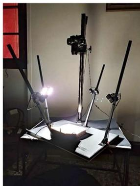
Figura 9: strumentazione per il photometric stereo composta da macchina fotografica, stativo, luci led e piano di acquisizione.
